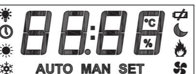
Indicatore a 4 digit multifunzione per visualizzazione temperatura, Set Point ridotto, orologio e impostazioni utente/installatore.
